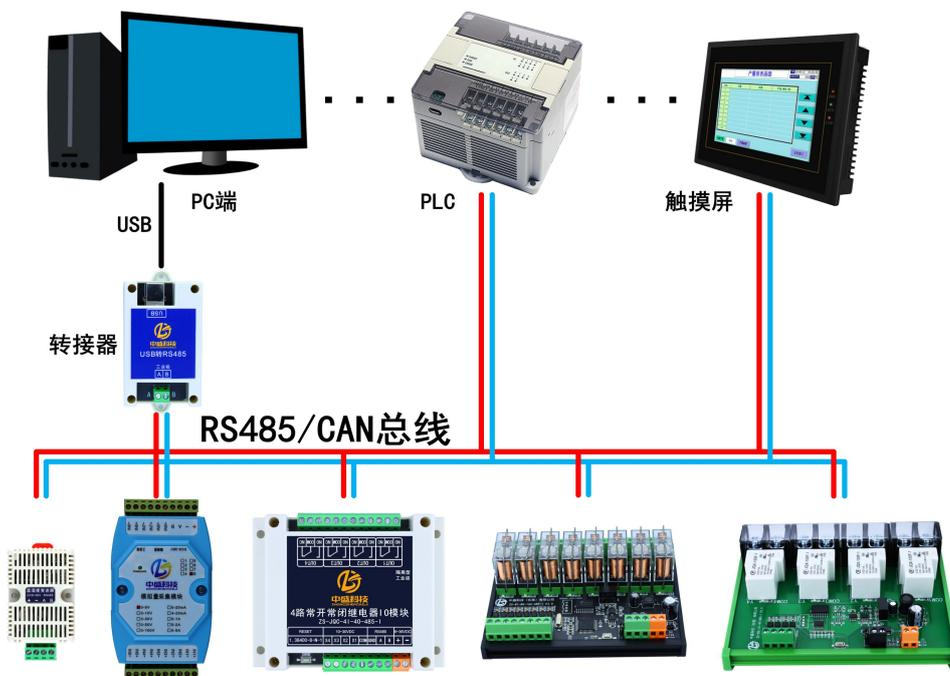
图 1.2 RS485 总线接线示意图
