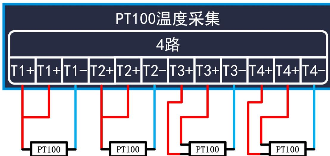
图 1.3 PT100 传感器接线示意图
